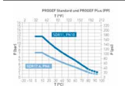
ABB. 5: ANWENDUNGSGRENZEN FÜR ROHRE UND FITTINGS AUS PPH
